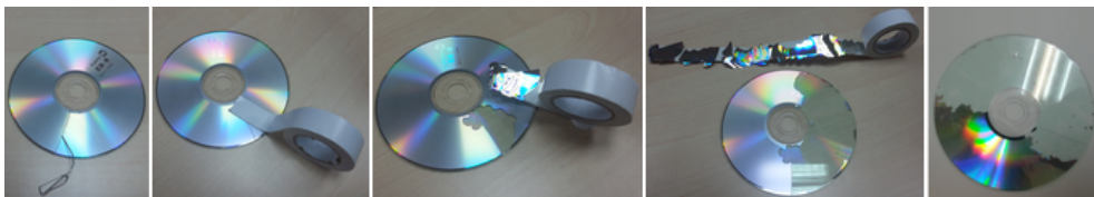
Фиг. 8. “Технология” за свалянето на фолиото от диска: 1) Фолиото се издрасква (разрязва) радиално с кламера; 2) Върху разреза се залепва лента; 3) Лентата се издърпва и фолиото остава залепнало за нея; 4) Залепването и издърпването на лентата се повтаря докато половината от диска се обели.
