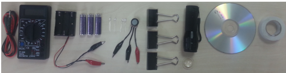
Фиг. 1. Детайли от комплекта за измерване на константата на Планк h : Проводници с щекер и щипка, мултиметър, държач за батерии и 3 батерии от 1.5 V, 4 светодиода, потенциометър с проводници и щипки, 3 щипки за хартия, фенерче и лещата му, компакт диск (CD) и двойно-залепваща лента, фоторезистор, непрозрачна тръбичка, пластелин, кламер.
